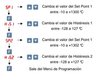
**Nota1:** Si se mantiene presionada una de las teclas , luego de un momento el valor comenzara a modificarse rápidamente. Si no se presiona ninguna tecla, pasado algunos segundos sale del Modo Programación, guardando los cambios y volviendo al Modo de Control.
